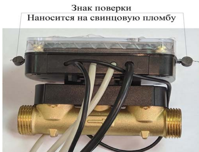
Пломба ресурсоснабжающей организации
