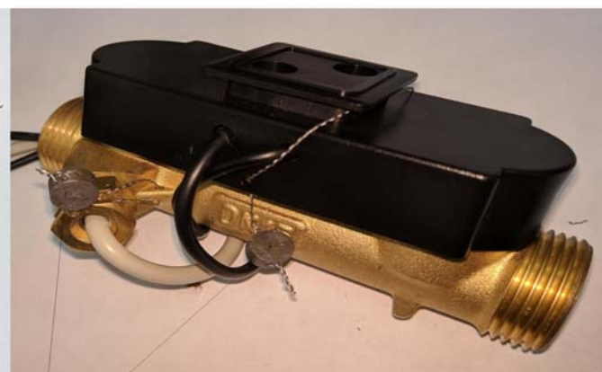
Знак поверки Наносится на свинцовую пломбу
